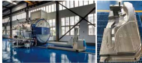
2018年7月底，宁兴特钢集团1.2米\*1.2米\*2米、承载7吨、15Bar压力的大型真空热处理设备调试完成，投入使用，此设备为目前国内最大的真空热处理设备。同时，大型的压铸模具材料也陆续到库。
